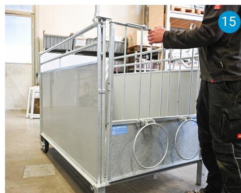
Nachdem das Grundgestell inkl. der oberen Versteifung mit den Faustschellen (13) montiert wurde, kann die Tür eingesetzt werden. Hierfür wird an die untere Flacheisenlasche der Türanschlagsseite eine Schraube M10 X 35, Mutter und Beilagscheibe montiert (14). Die Tür kann eingesetzt werden (15).
