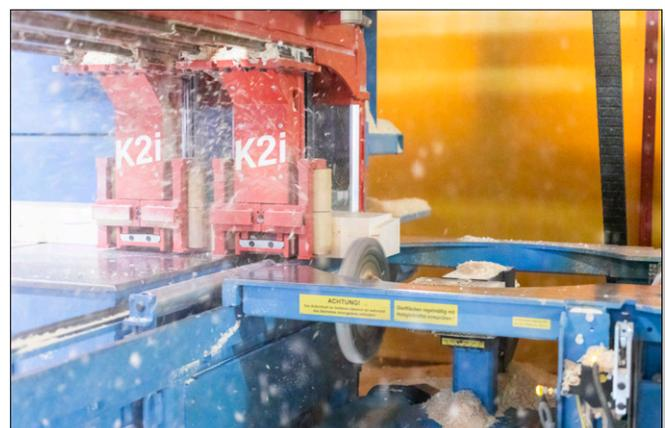
Portalbearbeitungszentrum für Vollholzwände und Fertighäuser
