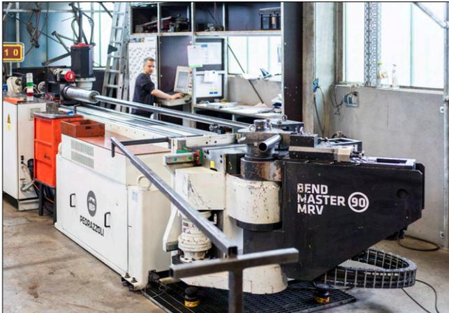
Mechanische Fertigung / Rohrbiegeautomat
