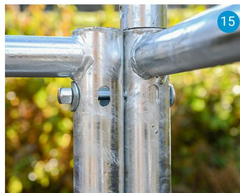
Nach diesen Schritten kann das Panel auf der Rückseite des Weidezelts, welches zwischen die beiden Seitenelemente kommt, montiert werden. Ein Spannungsgurt oder ähnliches hilft das Panel auszurichten (13/14) um anschließend mit Schlossschrauben M12 x 130 inkl. Beilagscheibe (gebogen) und Hutmutter M12 die Seitenpaneele und Zeltbögen mit dem Panel der Rückseite an allen 6 Verbindungspunkten zu verschrauben (15). Damit steht das Grundgerüst.
