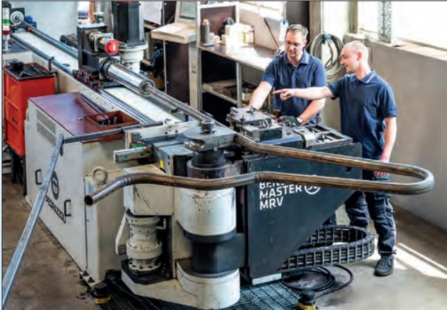
*Mechanische Fertigung / Rohrbiegeautomat*
