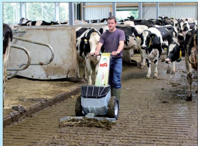
Spaltenschieber mit Akkubetrieb
