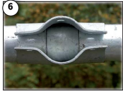
6 Auf 1. Zeltbogen je 5 Hutschellen aufschieben. Achtung: Die mittlere Schelle muss genau über dem Verbinder liegen, oben mittig.
