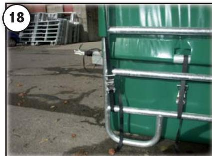
**18** Zum Schluss die Spanngurten der Giebelüberhänge straff ziehen und mit der Waagrechten des Zaunelementes (Ende Fuss) verbinden.
