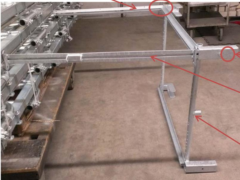
Seitenstreben vorne + hinten ins Rechteckrohr stecken und von Hand mit Schraube 10X70 + Beilagscheibe + Mutter festziehen
