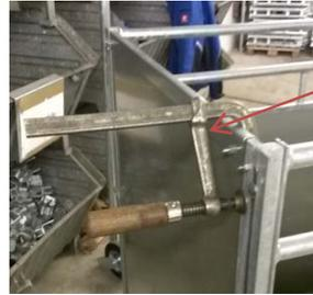
Mit einer Schraubzwinde fixieren
