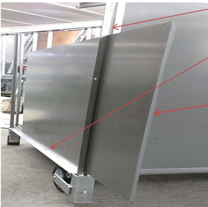
Seitenwand von hinten durch den Schlitz der Strebe schieben.
