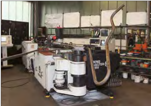
Mechanische Fertigung / Rohrbiegeautomat
