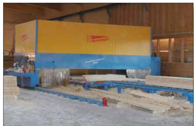
Portalbearbeitungszentrum für Vollholzwände und Fertighäuser
