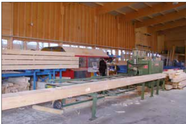
Blick in die Fertigungshalle mit modernster Abbundanlage
